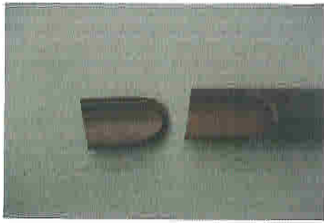
Bild 9: Innenoberfläche des Vinidur-Rohres Nr. 24 nach über 50jährigem Einsatz ohne Inkrustationen und Ablagerungen.
