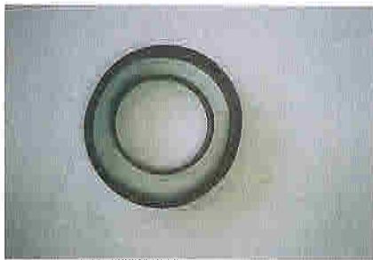
Bild 15: Querschnitt von 2 Vinidur-Rohringen aus Bitterfeld mit deutlicher Unrundheit und Wanddickenschwankungen.
